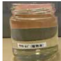
サナモールド RVO 表面にベタツキがあるが 溶解していない
